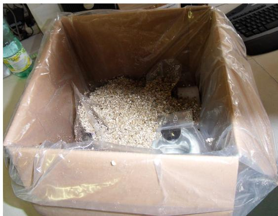
Détail d'une expédition d'alcool : les échantillons contenus dans des sacs plastiques sont recouverts de vermiculite.
