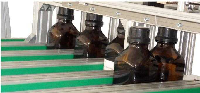
Ci-dessus : Le rack de l'automate de distribution de « grand volume », d'une capacité de 200 bouteilles de 1L.
